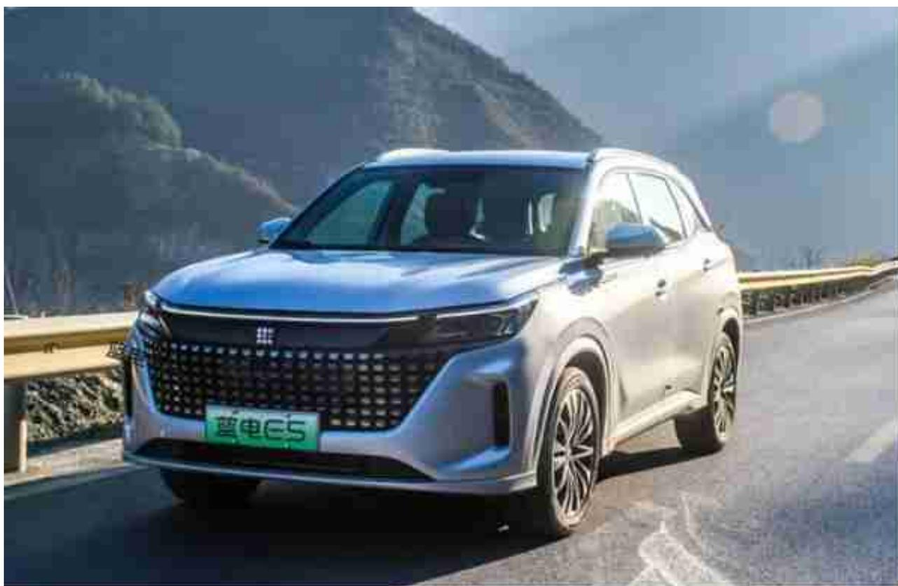
先来和各位聊聊蓝电E5搭载的这套弗迪动力混动系统，它的最大功率130kW、最大扭矩300N·m，百公里加速最低仅需7.4秒，起步就能快人一步，对于一台体型健壮的中型SUV来说显然性能十分出色。另外它还有一个特点，就是以纯电驱动为主，所以各位日常驾驶就如同在开一台纯电车型，蓝电E5发动机无感启停和无感直驱，能带来毫无顿挫感的丝滑驾享体验，因此整车NVH静音性、平顺性都挺不错。
